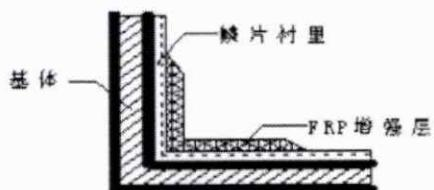
5.5.3 设备结构的形变敏感区(如内件支撑梁)应实施全结构增强，其纤维增强结构要求见下图。
